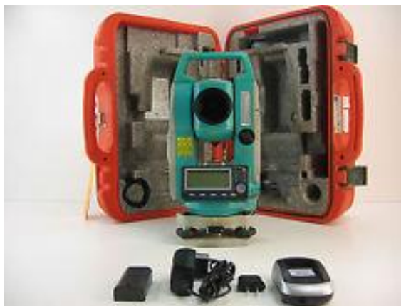
Foto 5- Modelo da estação total utilizada.
